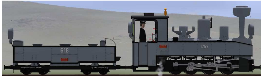
Henschel 15556 Bj 1917 – HF 1757 – Lok im Ablieferungszustand (grau) – heute im DDM. Tender 618 neue Bauform. (Modellname: Brigadelok1757, Tender618 – enthalten in: V70NKK10017)
