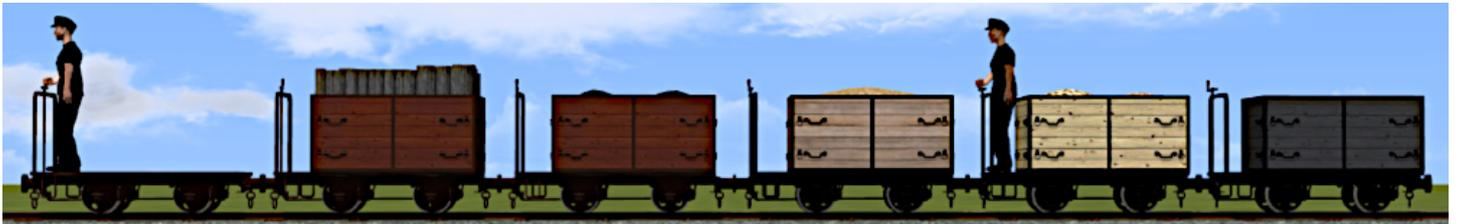
Für die Deutsche Heeresfeldbahn wurden die leichten Feldbahnwagen der alten Bauart auf Unterwagen mit 900mm Achsstand (ungebremst) und 1100 mm Achsstand (gebremst) aufgebaut. Wie lange Wagen dieser Bauart tatsächlich eingesetzt wurden ist nicht bekannt. Mindestens 4 Unterwagen existieren noch, allerdings nur als Flachwagen.
