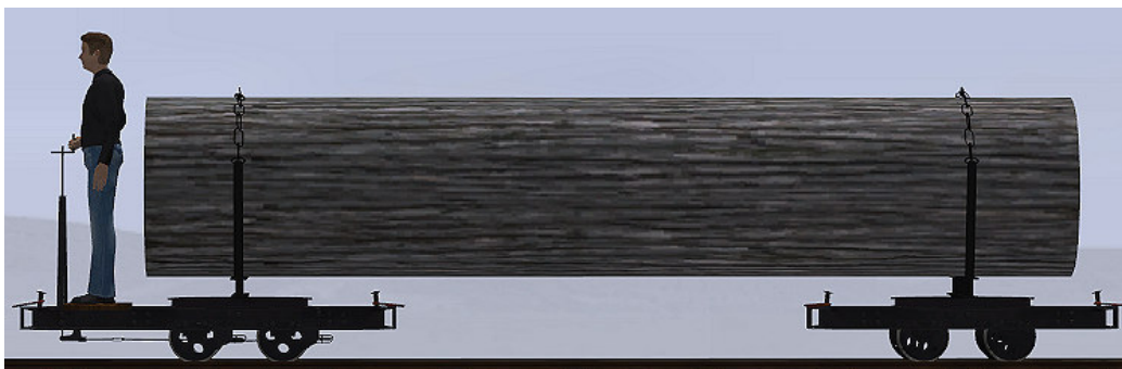
Drehschemel-Lore gebremst bel2l Länge: 6840 mm
