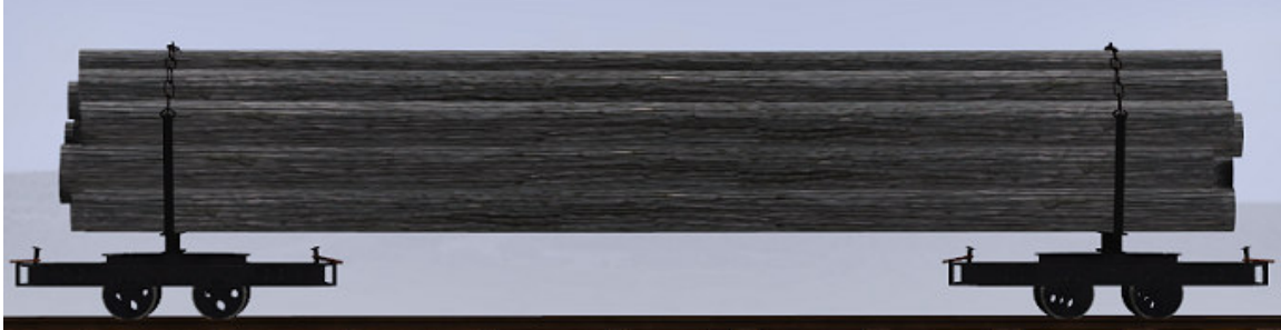
Drehschemel-Lore bel3 Länge: 7610 mm
