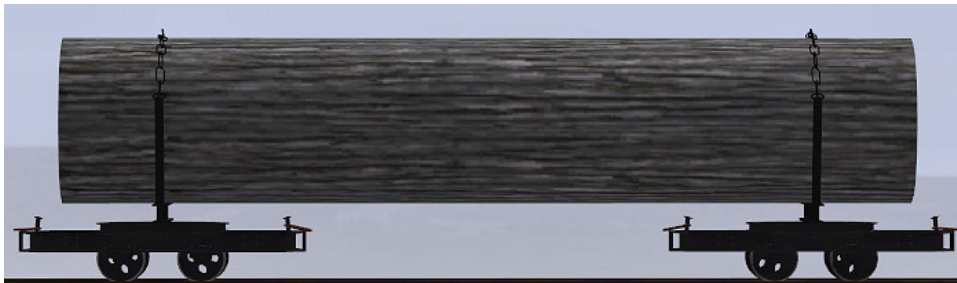
Drehschemel-Lore bel2 lang Länge: 6350 mm
