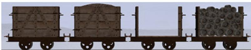
Torflore, 2-achsig mit beweglichen Seitenwänden, Torfladung (TT) und Holzladung
