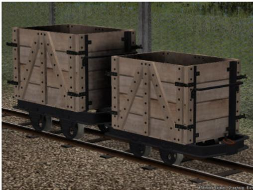
Im Bild links ist der Größenunterschied zwischen den Wagen mit 400 mm Rädern und den Wagen mit 350 mm Raddurchmesser (Torflore (klein)) zu sehen. Die kleineren Wagen gibt es nur in der Version mit beweglichen Seitenwänden und Torf- und Holzladung.
