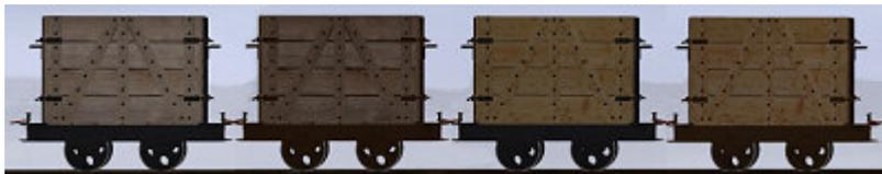
Torflore, 2-achsig mit festem Holzkastenaufbau und beweglicher Torfladung (TT)
