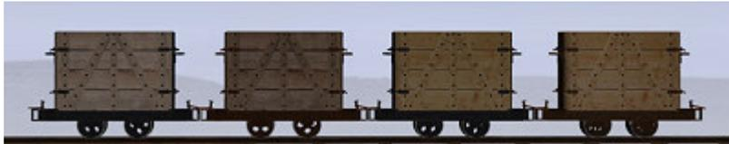
Kleinere Torflore, 2-achsrig mit beweglichen Seitenwänden, Torfladung (TT) und Holzladung
