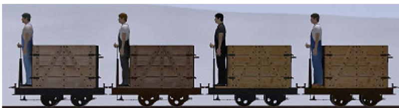
Gebremste Torflore, 2-achsig mit festem Holzkastenaufbau und beweglicher Torfladung (TT)
