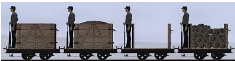
Torflore, 2-achsig mit beweglichen Seitenwänden, Torfladung (TT) und Holzladung
