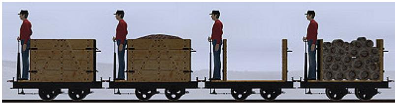
Torflore, 2-achsiger mit beweglichen Seitenwänden, Torfladung (TT) und Holzladung
