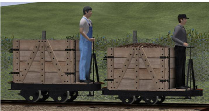
Im Bild links ist der Größenunterschied zwischen den Wagen mit 400 mm Rädern und den Wagen mit 350 mm Raddurchmesser (Torflores (klein)) zu sehen. Die kleineren Wagen gibt es nur in der Version mit festen Seitenwänden und Torfladung.
