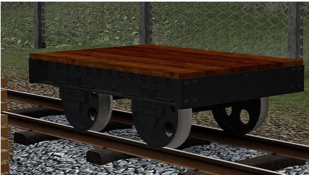
Einfacher Plattformwagen ohne Kupplungs- und Stoß-Einrichtungen, wahrscheinlich für reinen Handbetrieb gedacht.
