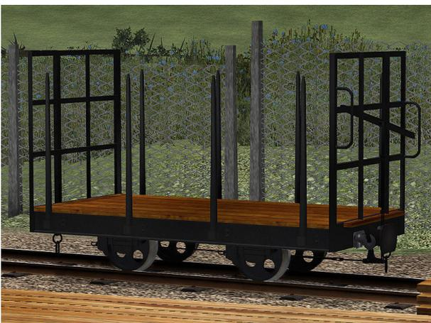
Scheidholzwagen mit einsteckbaren Rungen, Puffern und Kupplungen. Die Achsen sind einseitig abgebremst, die Bedienung erfolgt über einen Bremshebel, der über die gesamte Wagenseite ausgeführt ist, so daß von jeder Wagenseite aus genutzt werden kann.
