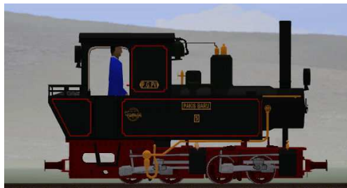
O&K 14730 Bj 1905 – PAKIS BARU Nr 5 – Außenrahmen, 2. Dom, Glocke. (Modellname: Mallet_PAKIS_BARU – enthalten in: V70NKK10015)
