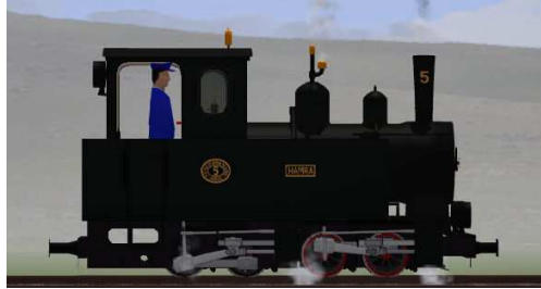
O&K 930 Bj 1902 – HAMRA Nr 5 – Außenrahmen, geänderter Kessel, Dome und Domventile. (Modellname: Mallet_HAMRA – enthalten in: V70NKK10015)
